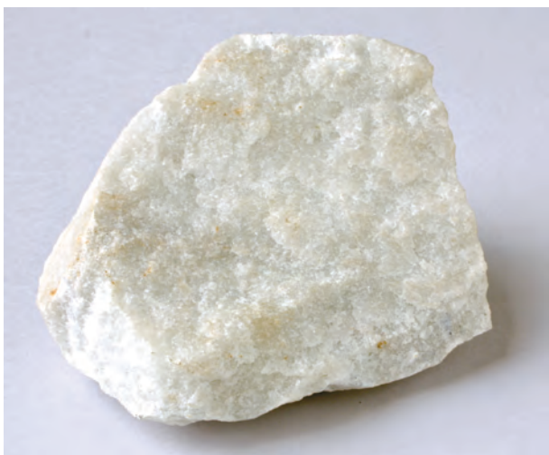
図2-22 結晶質石灰岩（階上町金山沢、幅10cm） ※p.43「青森白大理石」参照
