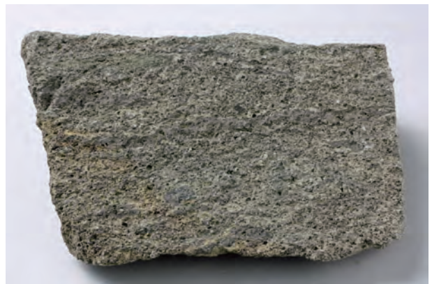
図2-31 溶結凝灰岩（中泊町小泊、幅12cm） 大陸の一部だった頃の陸上で堆積した凝灰岩
